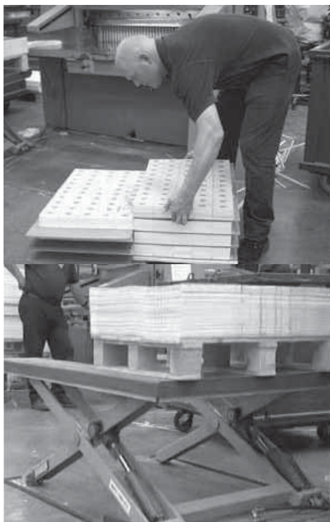
Slika 1: a) nefiziološki položaj tela i telesna naprezanja; b) rešenje problema sa podesivim po visini pneumatskim stolom
