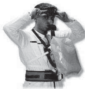
Slika 5. Uređaj za spašavanje sa hemijskim kiseonikom
