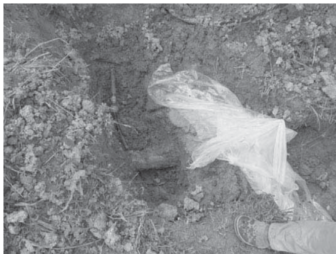
Slika 8. Klizište aktivirano pucanjem cijevi – Bare (foto: T. Nikolić, maj 2014.)
